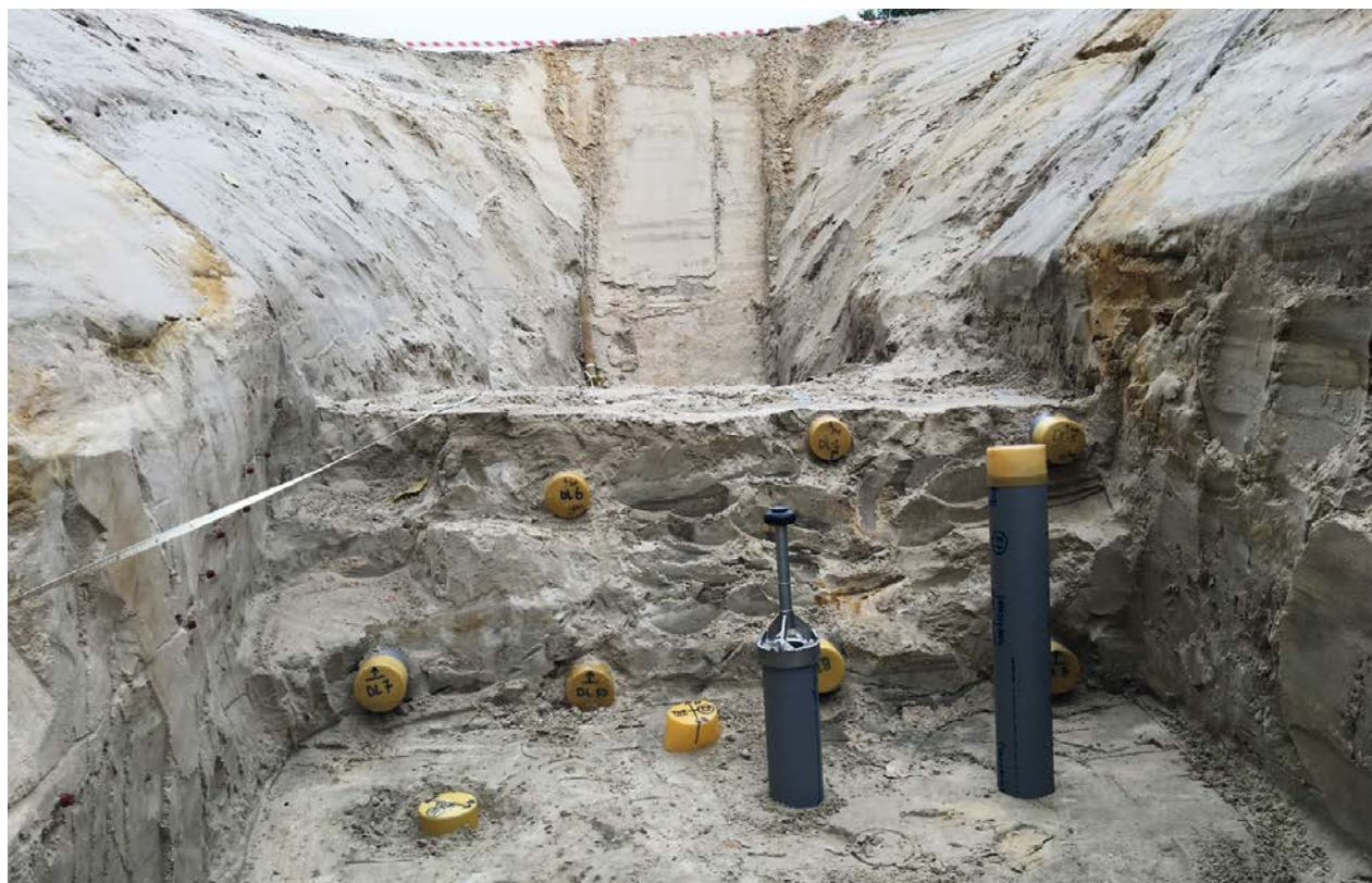
AFBEELDING 7. | Bemonstering van de Peelrandbreukzone in horizontale en verticale richting met 60 centimeter lange buizen (Ø 100 mm) voor het prepareren van de waterdoorlatendheidsmonsters in het laboratorium. In totaal werden 37 buizen geplaatst waaruit in verschillende afzettingen 150 monsters zijn geprepareerd.
