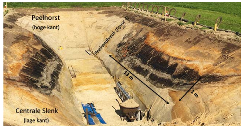
AFBEELDING 5. | Impressie van de omvang en opbouw van de onderzoeksleuf met aan weerszijden een circa 1 meter dikke en 13 meter brede structuur opgevuld met organisch (gyttja) materiaal.
